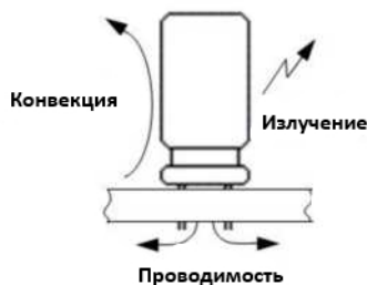
Рис. 4. Механизмы охлаждения электролитических конденсаторов
