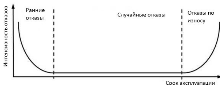
Рис. 6. Зависимость интенсивности отказов от времени
