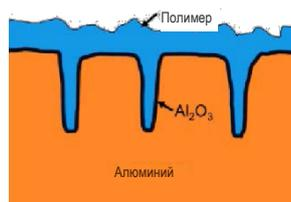
**Рис. 4. Поперечный разрез анода алюминиевого электролитического конденсатора с проводящим полимером (упрощенный)**
