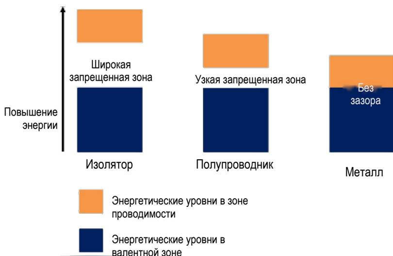
**Рис. 2. Упрощенное представление энергетических зон для различных материалов [9]**
