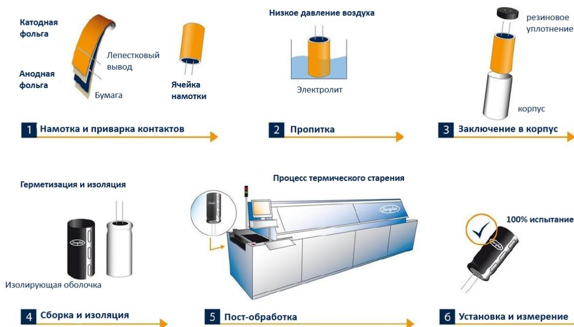
Рис. 3. Технологические шаги от сырья до конденсатора
